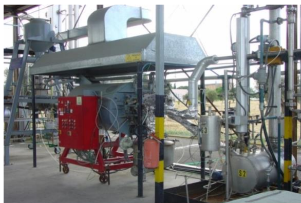
Figura 35: Impianto di pirolisi – gassificazione a tamburo rotante
